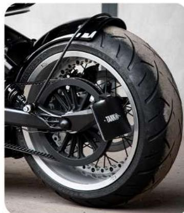
**6) a/ Placer le support sur le côté gauche en réutilisant l'axe de roue d'origine.**
